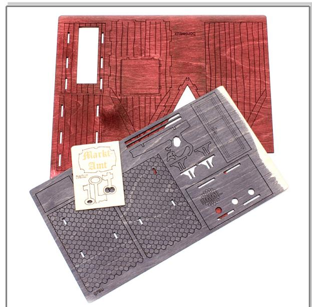
Im ersten Arbeitsschritt wird die Seitenwand mit der Tür vorbereitet. Dazu muss die Tür hinter die Seitenwand geleimt werden. Geben Sie ein paar Tropfen Leim auf die Tür und setzen Sie diese hinter die Wand. Zum Trocknen können Sie die Teile etwas beschweren oder Bastel- bzw. Wäscheklammern verwenden.
